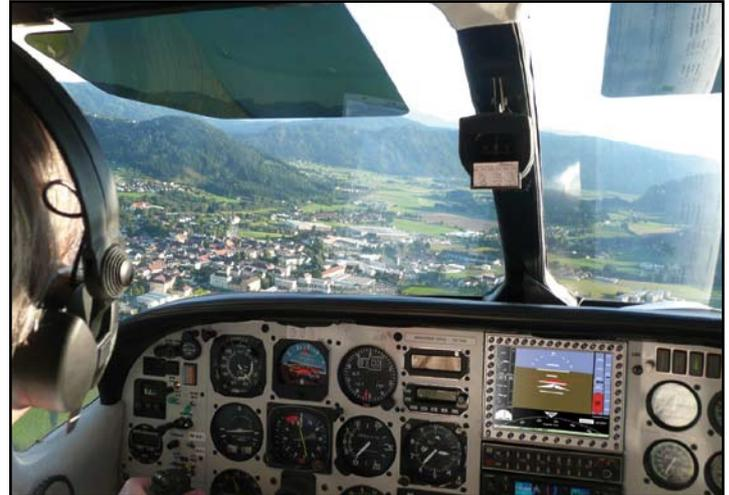
„Die Anstellwinkelanzeige, die den Piloten vor der Annäherung an gefährliche Flugzustände warnt, und die Anzeige der Flugbahnneigung bringen für ein Leichtflugzeug eine ganz neue Informationsqualität ins Cockpit“
