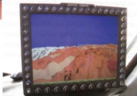
Wir wollen das Vision Air X heute genauer und im Flug unter die Lupe nehmen. „Was brauchen wir zum Einbau?“, frage ich Stefan Unzicker. „Nix“, ist die Antwort. „Alles drin. Akkus, GPS, Datenmodem.“ Er nimmt das Gerät aus dem Koffer, schaltet es an und wir können im Prinzip sofort los.
