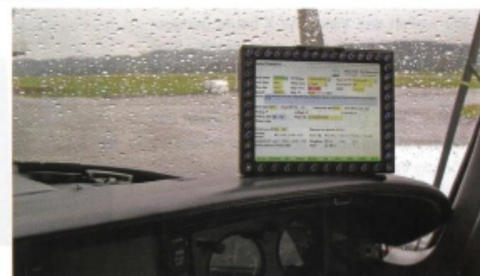
**MT Blitzplan:** Der Flugplan kann Sekunden vor dem Startup aufgegeben werden. Das Linux-basierte MT Vision Air X nutzt für die Blitzplan-Funktionalität einen Microbrowser und arbeitet den Workflow auf einer Internetseite ab.
