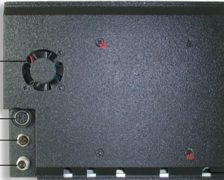
Öffnungen für Kabel zur Hardware-Peripherie
